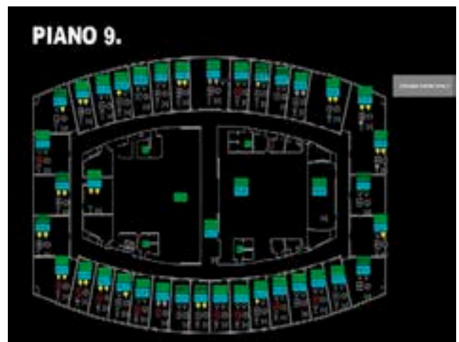
Figura 5 – Interfaccia per il controllo dei parametri microclimatici di un intero piano visualizzabile dal personale addetto alla manutenzione su PC e smartphone
