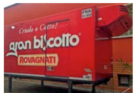
Figura 1 – Foto del cargo refrigerato equipaggiato con l'unità frigorifera utilizzata
