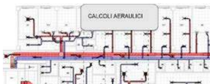
Figura 8 – Esempio di distribuzione aerea ottenuta con il metodo della modellazione dinamica
